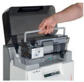
Stockage des cartes vierges dans un chargeur amovible d'une capacité de 250 cartes
